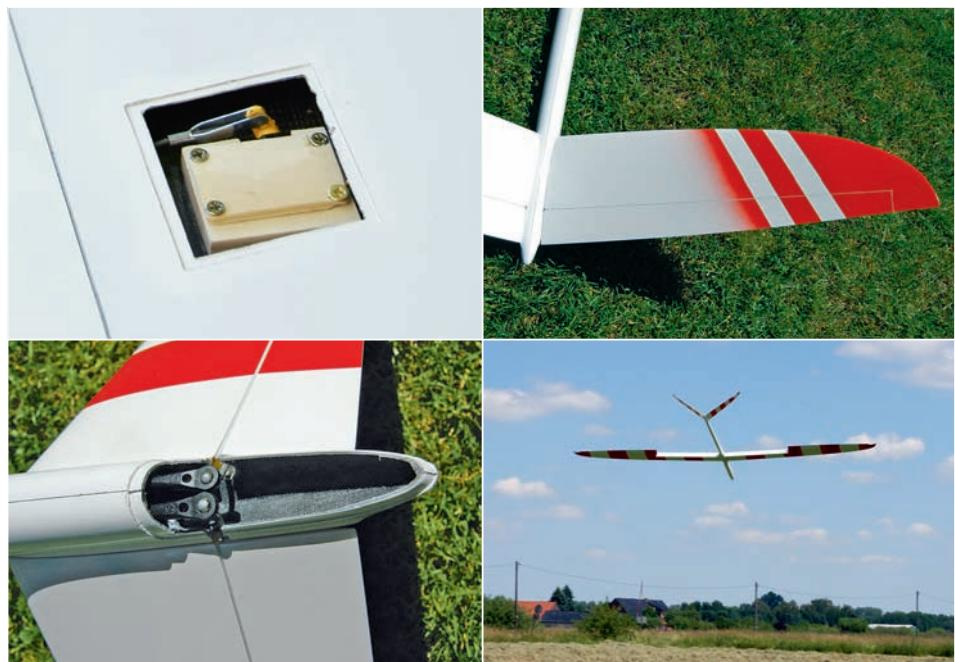
**Einbau der Servos mit selbstgebauten Einbaurahmen · Die Passung des V-Leitwerks am Rumpf ist exzellent · Am Rumpfende befindet sich ein abnehmbarer Rumpfdeckel für die Anlenkungen des V-Leitwerks · Die Butterfly-Stellung benötigt eine deutliche Beimischung von Tiefenruder, die Landungen gelingen dann butterweich und mit sehr geringem Tempo · Bilder unten: Abwurf des Modells bei sechs Beaufort.**
