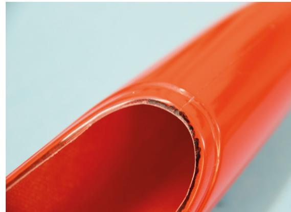
Der Rumpf muss im Kabinenbereich stark besäumt werden, sonst gehen die Einbauten nicht rein.
