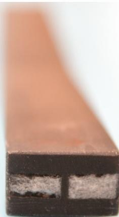
Marmor, Stein und Eisen bricht, aber dieser Verbinder nicht. Er misst im Querschnitt satte 25x15 mm.
