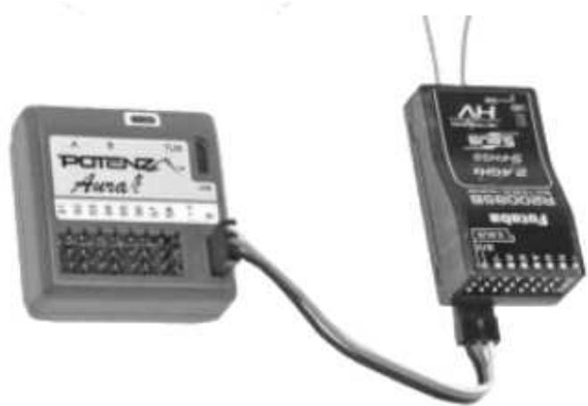
4. Bei eingeschaltetem Sender schalten Sie die Empfangsanlage ein. Die Aura beginnt danach mit dem automatischen Erkennen der Empfängersignale. Sobald alles ordnungsgemäß erkannt ist und die Kalibrierung abgeschlossen ist, leuchtet die orange LED, sowie die grüne ständig auf.
