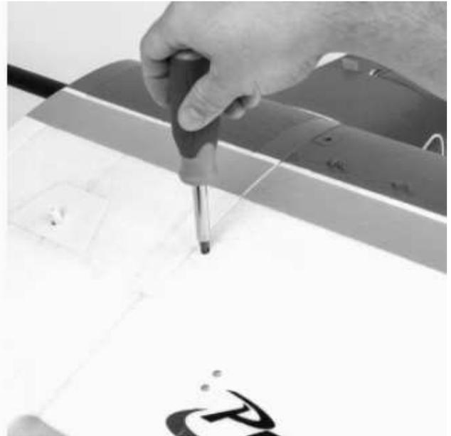
5. Beachten Sie, die Flächenstreben sind für die beiden Flächenhälften unterschiedlich, Sie sind am unteren Ende mit 'L' für links und mit 'R' für rechts gekennzeichnet. Beachten Sie auch, dass es zwei unterschiedliche Strebenhalterstifte gibt, ein Paar (A) ist kürzer und ein Paar (B) ist länger. Die Halterungen mit der Bezeichnung (A) gehören an die Rumpf-, die mit der Bezeichnung (B) gehören an die Flächenseite.
