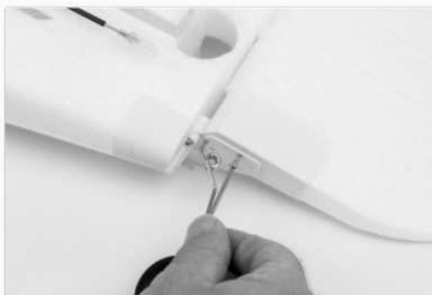
6. Schließen Sie den Gabelkopf des Rudergestänges am innersten Loch des Ruderhorns an. Schieben Sie den durchsichtigen Schlauch über den Gabelkopf, um ihn sicher zu befestigen. Nach der kompletten Montage und dem Anschluss des Servos am Empfänger, drehen Sie den Gabelkopf so, dass das Seitenruder genau mittig steht. Dabei muss das Servo exakt in der Neutralposition stehen. **Verwenden Sie nicht die Trimmung oder die Servo Neutral Einstellung am Sender.**
