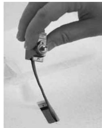
Tipp: Stecken Sie ein Ersatz Verlängerungskabel beim Entfernen an das Servo, um einen erneuten Einbau zu erleichtern.
